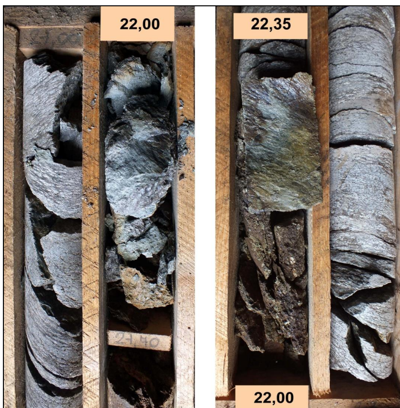
Obr. 101 Detailní pohled na úsek jádra 21,70-22,00 m (vlevo) a 22,00 - 22,35 m (vpravo) jádra s patrnou sericitizací na foliačních plochách i na puklinách kosých k foliaci. V úseku 22,00 - 22,20 je patrný soudržený kataklazit (tektonická mikrobrekcie) (foto I. Prachař, 2013).
