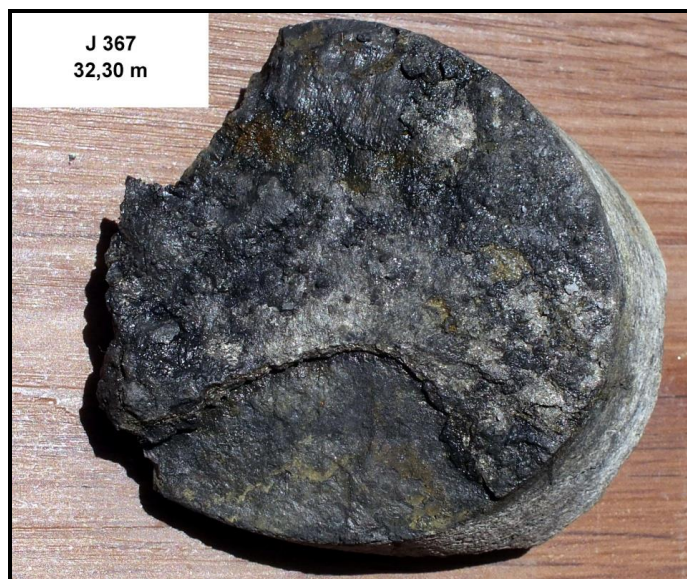
Obr. 107 Detailní pohled na polohu pseudotachylitu v duktilním mylonitu. Plocha je bez striací, silně pyritizovaná (foto I. Prachař, 2013).
