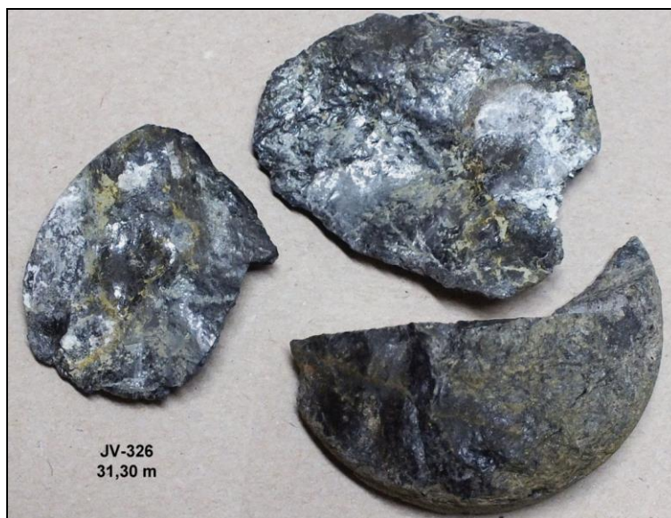
Obr. 103 Detailní pohled na ploché úlomky duktilního mylonitu s plochami odlučnosti po foliaci s ohlasy a černými kysličníky železa (foto I. Prachař, 2014).
