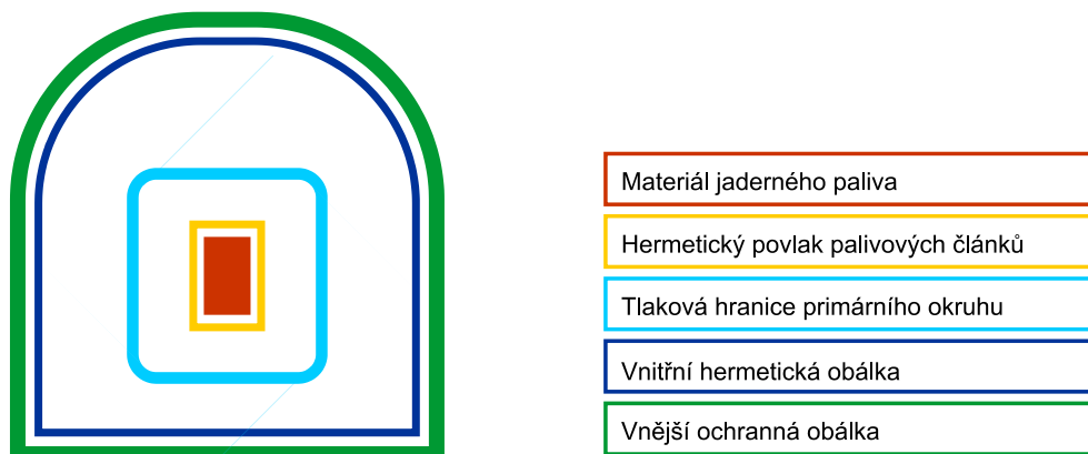
Obr. G.10: Fyzické bariéry proti úniku radioaktivních látek
